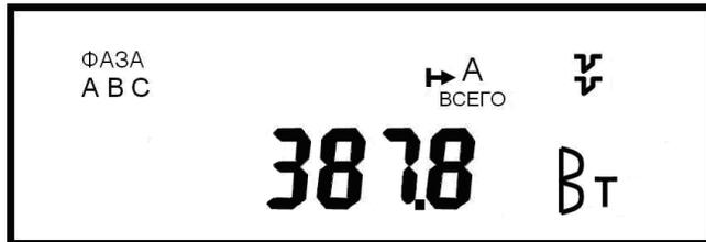
Рисунок Д.10 - Пример индикации значения суммарной активной мощности
