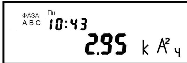
Рисунок Д.18 - Пример индикации значения удельной энергии потерь в цепях тока
