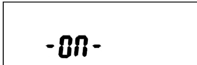
Рисунок Д.23 - Пример индикации готовности к работе оптопорта
