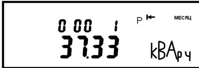
Рисунок Д.7 - Пример индикации значения емкостной реактивной энергии на РДЧ. В поле «Дата/Время» индицируется РДЧ
