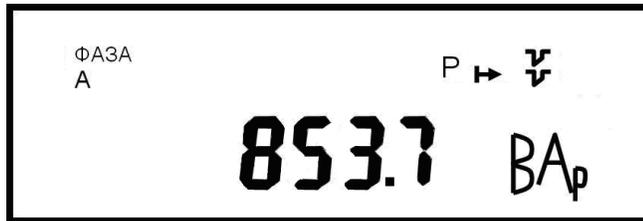
Рисунок Д.11 - Пример индикации значения индуктивной реактивной мощности по фазе А
